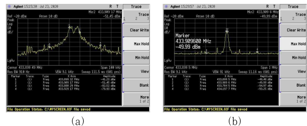
그림 2. 주파수별 신호세기 (a) Span: 100 MHz (2) Span: 1 MHz
